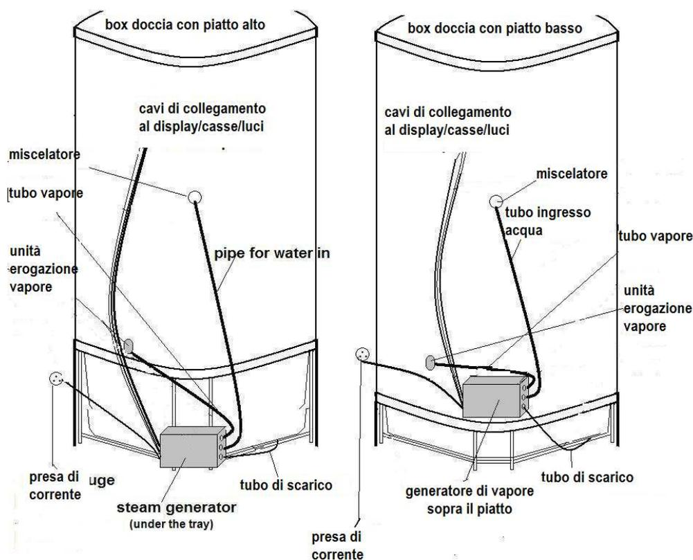
LO SCARICO DEL GENERATORE DI VAPORE VA COLLEGATO ALL'ATTACCO PREDISPOSTO DELLA PILETTA MONTATA SOTTO IL PIATTO DOCCIA / VASCA. L'ATTACCO POTREBBE ESSERE CHIUSO, IN QUESTO CASO APRIRLO UTILIZZANDO UN TRAPANO CON UNA PUNTA DA 6 mm.
