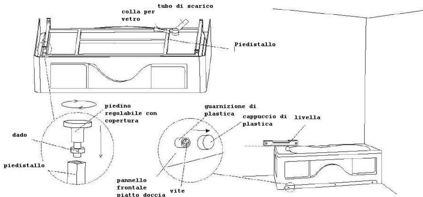
3.1. Controllare lo scarico. In caso di perdite, servirsi della colla vetro per fissarlo.
