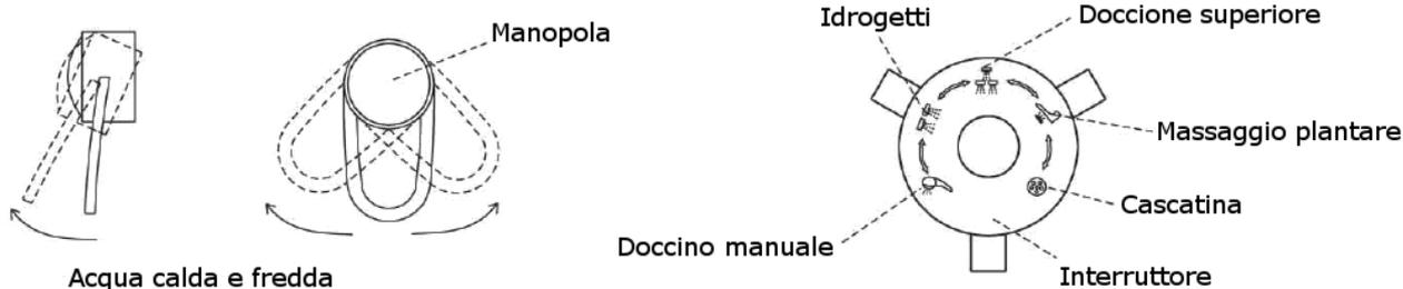
9.1 Prendere familiarità con il pannello di controllo, il rubinetto e il mixer (NB: la figura sopra riportata indica un miscelatore classico, per la versione con termostatico l'estetica e le funzionalità cambiano leggermente).
