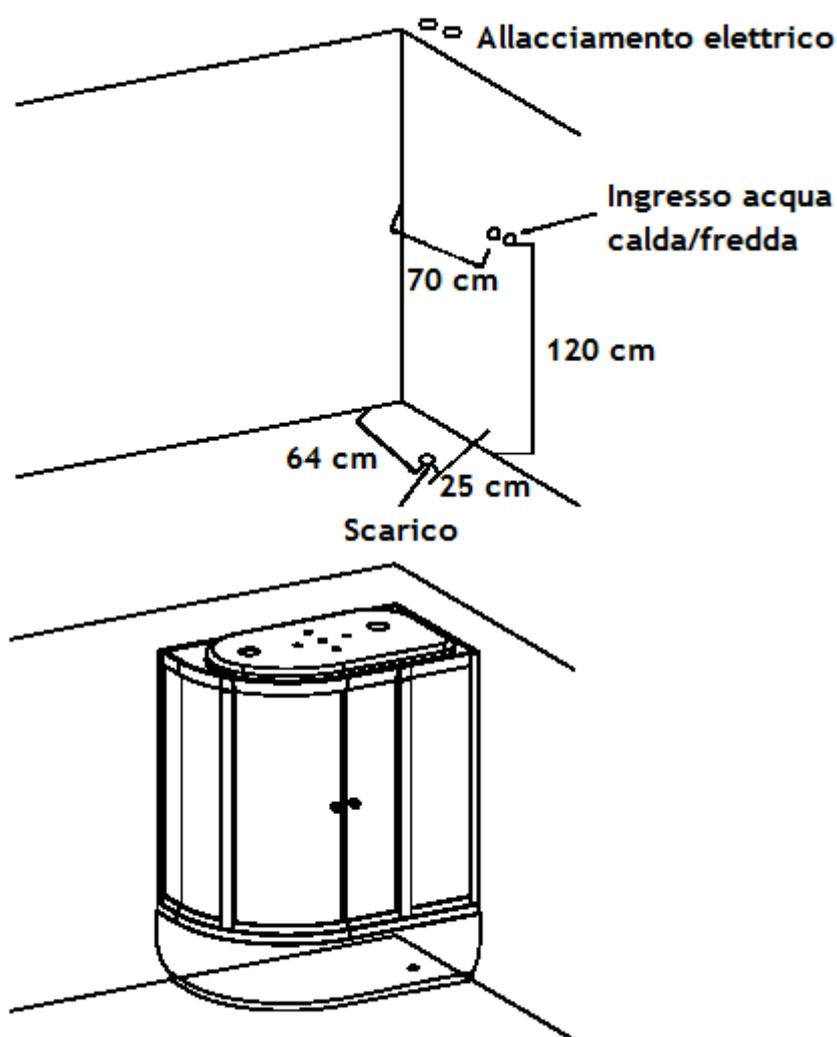
Gli attacchi idrici, si trovano dietro al miscelatore (a metà circa del lato corto da 85/100 che va in appoggio) ad una altezza di 120 cm circa, si tenga conto che in ingresso la doccia si collega tramite 2 comuni flessibili (attacco da 1/2 pollice) ai tubi acqua calda e fredda senza particolari predisposizioni.
