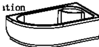
**Fase 2: Regolazione livello.** Appoggiare la livella sulla vasca, controllare e sistemare i piedini fino a che tutto sia piano, poi usare la chiave inglese per fissare il dado.
