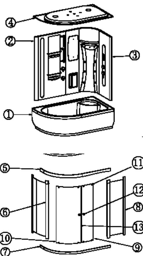
L'installazione del box doccia non necessita di particolari predisposizioni, in quanto i collegamenti di acqua calda, fredda e scarico sono da effettuarsi con tubazioni flessibili che non richiedono misure specifiche di uscita dei raccordi dal muro e dal pavimento. In particolare, per quanto riguarda lo scarico, tra il piatto doccia ed il pavimento c'è un'altezza
