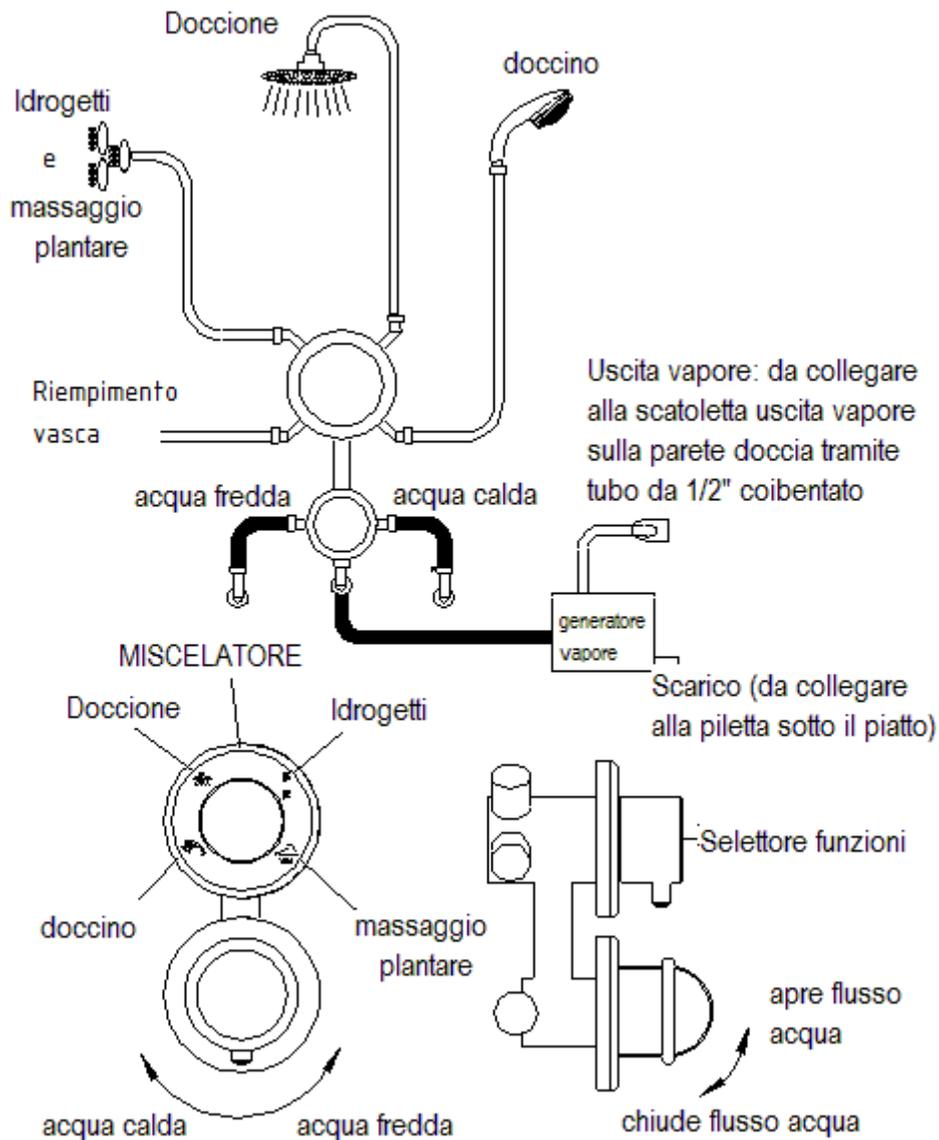
LO SCARICO DEL GENERATORE DI VAPORE VA COLLEGATO ALL'ATTACCO PREDISPOSTO DELLA PILETTA MONTATA SOTTO IL PIATTO DOCCIA / VASCA. L'ATTACCO POTREBBE ESSERE CHIUSO, IN QUESTO CASO APRIRLO UTILIZZANDO UN TRAPANO CON UNA PUNTA DA 6 mm.
