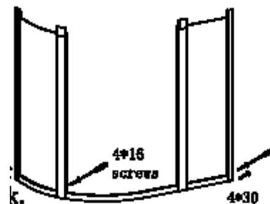
3. Dopo aver fissato il binario inferiore con i vetri fissi appoggiare sopra il binario superiore, usare viti da 4x30 e 4x16 per fissarlo ai vetri fissi.
