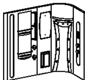
**Fase 4: Collegamento dei pannelli posteriori e della vasca.** Mettere il pannello posteriore sulla vasca, poi usare le viti M6x25 per fissarli seguendo i fori. In caso i fori non coincidano praticarne di nuovi o allargare i presenti.
