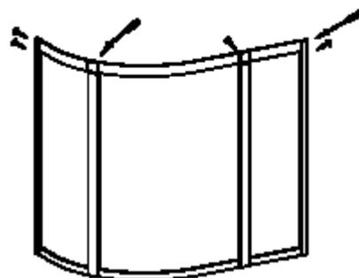
4. Installare la porta scorrevole. Installare prima le rotelle superiori, poi appenderla alla struttura fissa, poi installare le rotelle inferiori posizionando perfettamente la porta.
