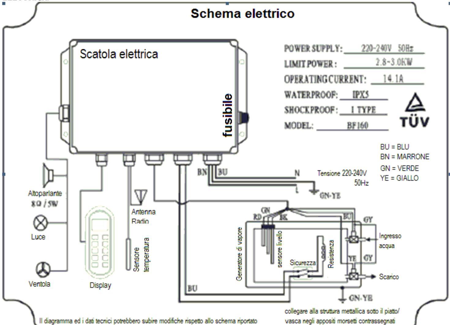
Lo schema si riferisce solamente all'impianto doccia ( l'alimentazione della pompa idromassaggio della vasca è separata )
