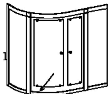
5. Installare la struttura a vetri sulla vasca, usare viti per fissare il pannello posteriore e la struttura di vetro.
