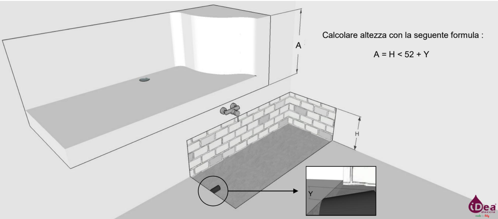
Rifilare la monoscocca all'altezza ottenuta con una smerigliatrice provvista di disco da 1,5 mm
