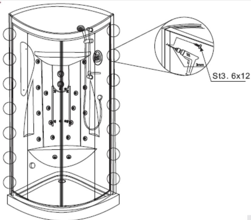
5.4 Fissare la struttura con le viti come da figura
