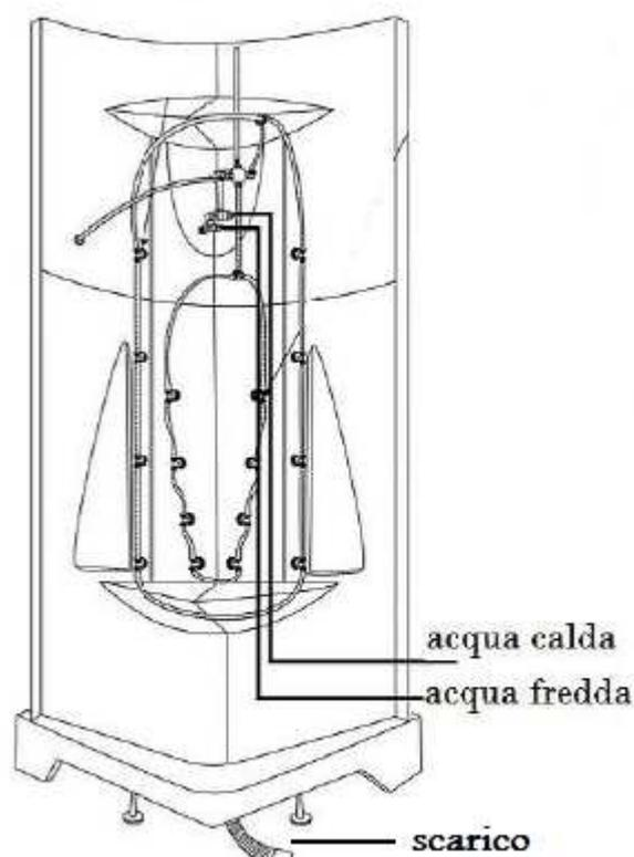
7.1 Collegare la doccia, i tubi per l'acqua calda e fredda e lo scarico (attenzione: i tubi non sono forniti in dotazione e devono essere acquistati separatamente). Stringere adeguatamente con una chiave inglese.
