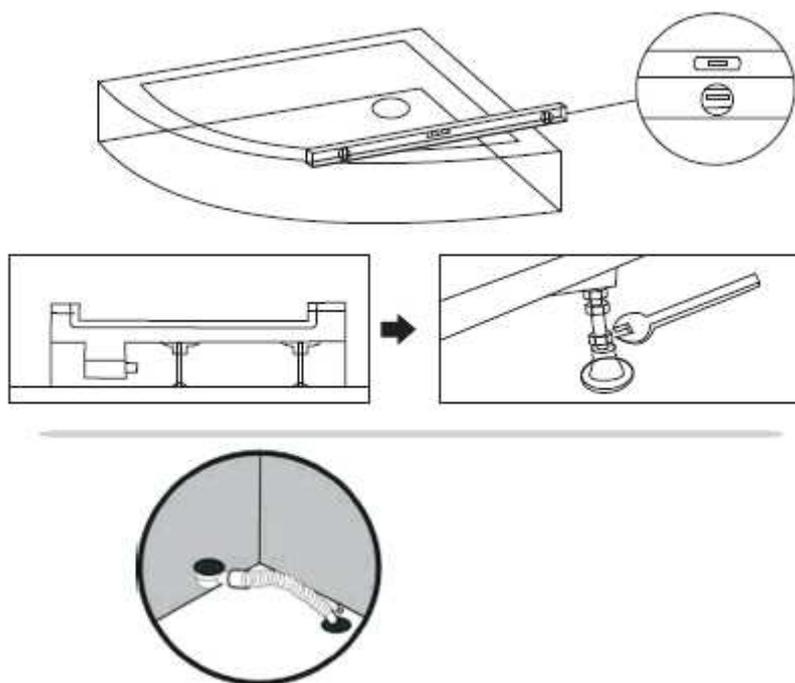
3.1. Controllare lo scarico. In caso di perdite, servirsi della colla vetro per fissarlo.
