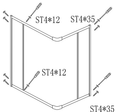
4. Installare la struttura a vetri sulla base, usare viti 4x20 per fissare il pannello posteriore alla struttura della vetrata.
